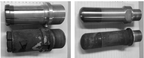
图5 试验前后动静弧触头烧蚀状态对比
